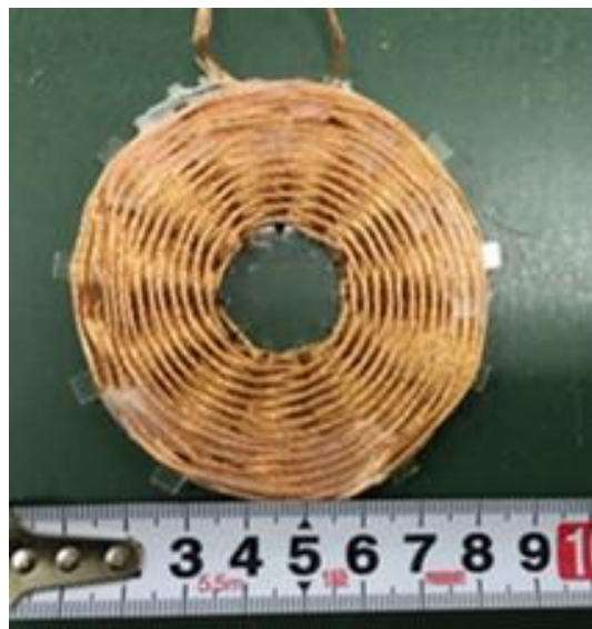
Fig. 19 非接触給電で用いたコイル
