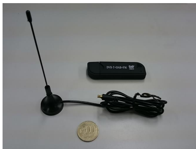
図 2.7. ADS-B データの受信用アンテナ
