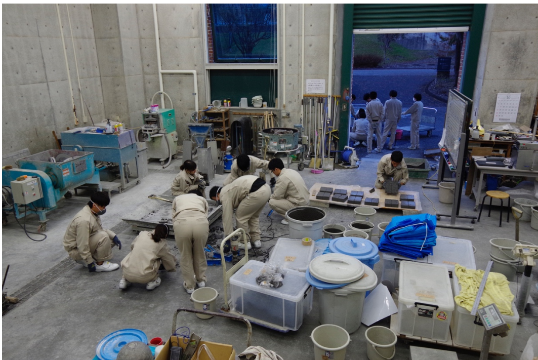
図 4-38. 木灰コンクリートブロック作成の様子
