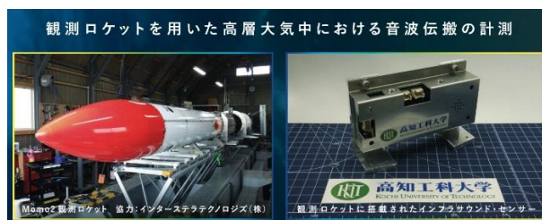
図 8. 観測ロケット Momo および搭載センサー
