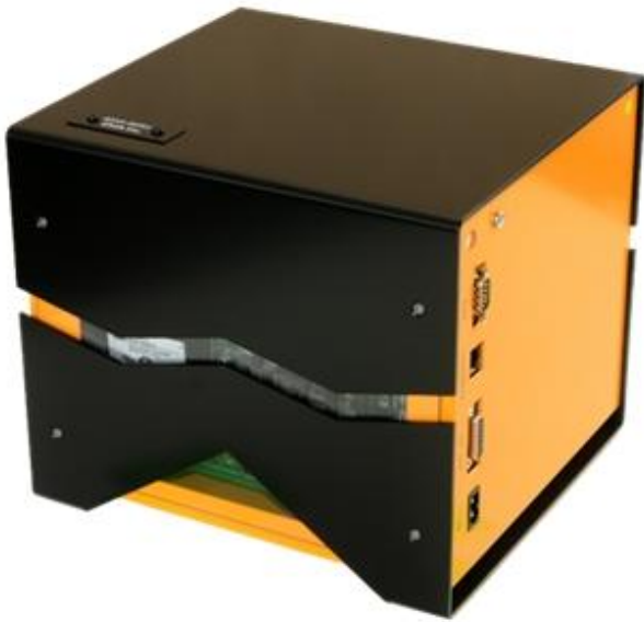
図3. 複合型インフラサウンドセンサー
