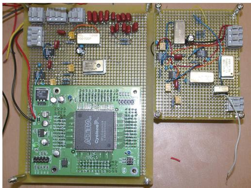
図7 FPGAを用いて試作した回路基板
