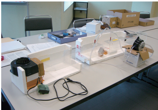
図12. 簡易風洞 (左:ファン、右:微差圧計)
