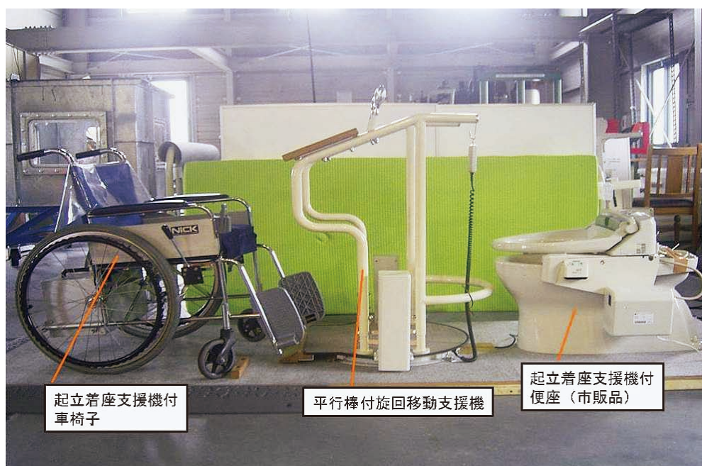
写真3 試作した旋回移乗介護装置
