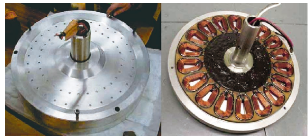
図4 開発された発電機外観とコイル組み立て外観(株式会社スカイ電子製作)
