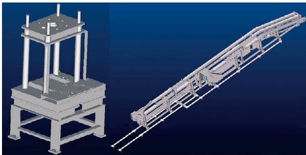
図9 ベアリングセッティングジグとエルボパイプの選別用コンベア
