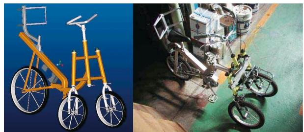
図 12 前2輪の電動アシスト3輪自転車
