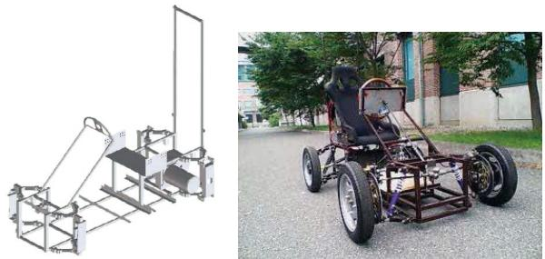
図 11 第3号の手作り小型電気自動車のフレームと出来上がり
