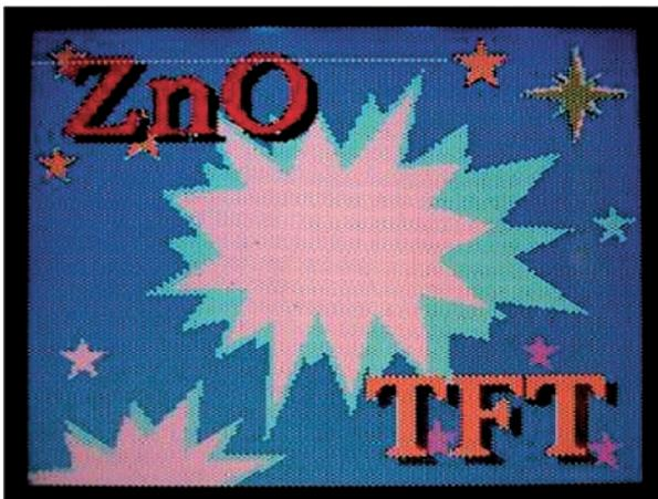
図 12 ZnO TFT アクティブマトリクス駆動液晶ディスプレイの画像表示例
