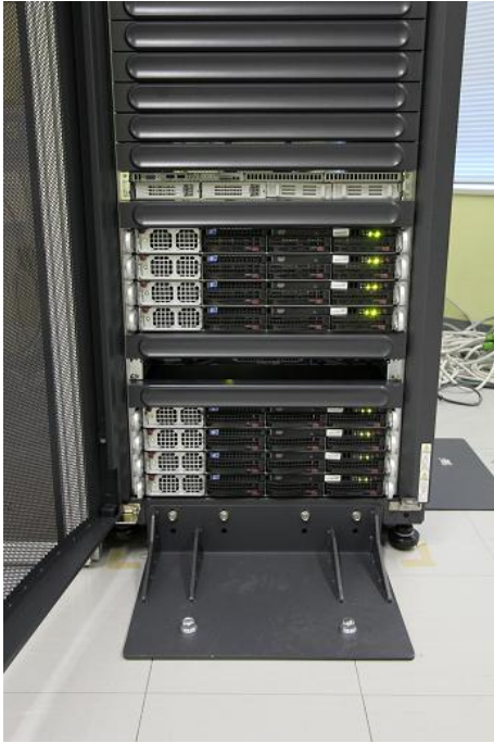
図 6 平成 22 年度に本学に導入した GPU クラスタ。NVIDIA 社 C2050 を 16 個搭載し、ノード間を 40Gbps の Infiniband でつなぐ。
