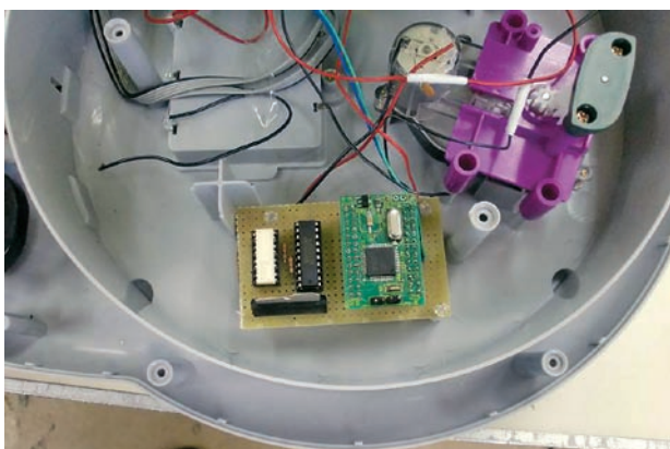
制御対象に組み込んだ制御回路
