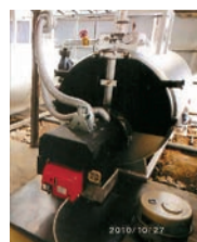
Fig.2 ペレットバーナーの仕様 (a)外観 (b)仕様表
