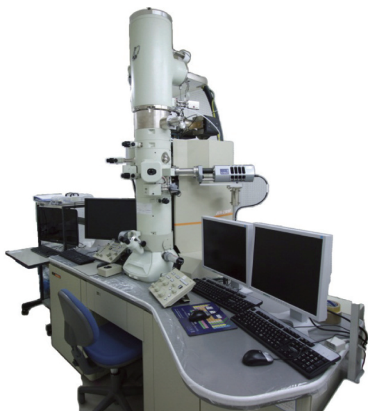
図7 透過型電子顕微鏡 (JEM-2100F)
