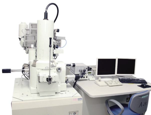
図6 走査型電子顕微鏡 (JSM-7401F)
