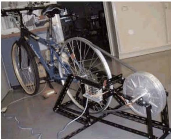
図 6. コアレス発電機を用いた人力発電機
