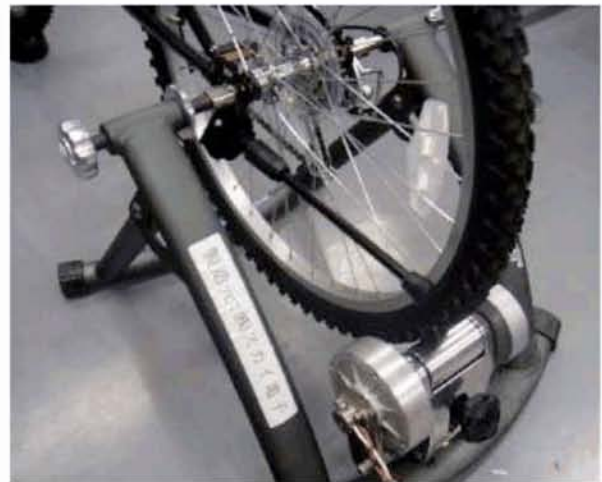
図 7. 自転車トレーナーを改造した人力発電機
