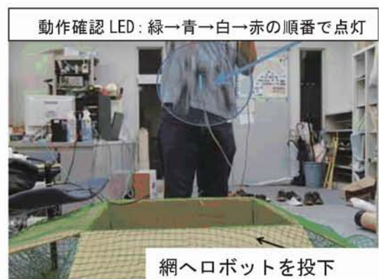
図 13. 落下実験の様子
