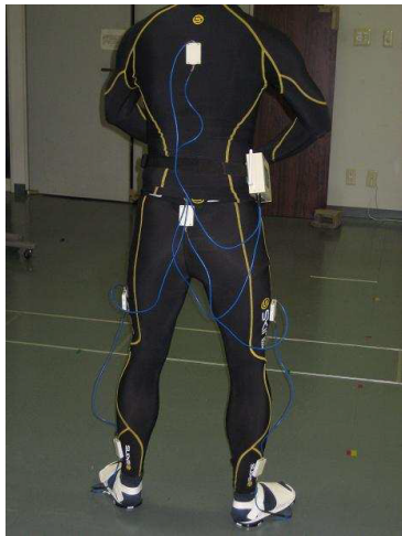
図 13. ウェアラブル運動解析システム (装着時の外観)
