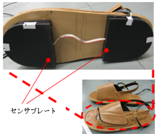
(b) 履物に装着したセンサプレート
