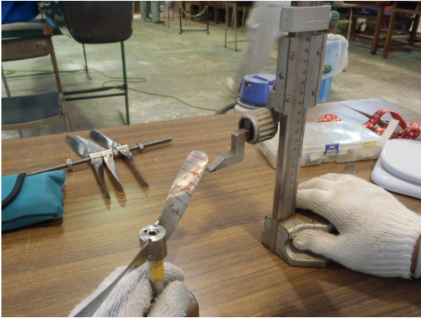
写真1. プロペラピッチの計測
