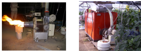
図2. 開発した木質ペレット燃焼機 4)
