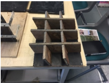
図 15. 溝部分の型枠組み立てた状態
