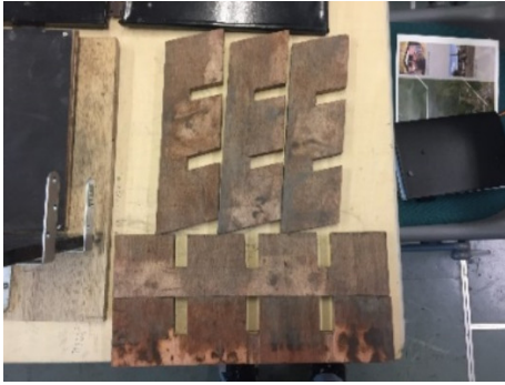
図 14. 溝部分の型枠分解した状態
