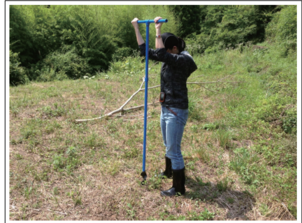
図6. ハンドオーガーによる掘削
