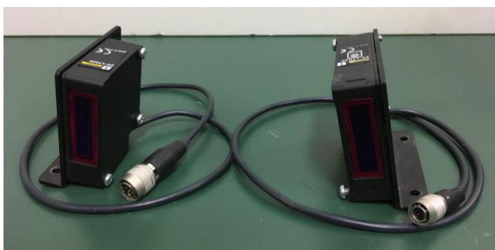
Fig. 20 透過型レーザーセンサ
