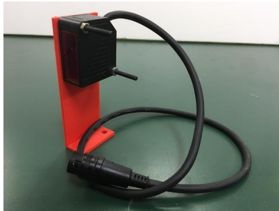
Fig. 21 反射型レーザーセンサ 1
