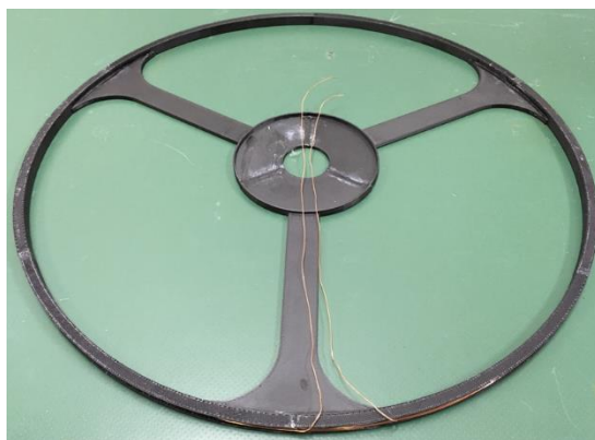
Fig. 19 製作した浮上コイル
