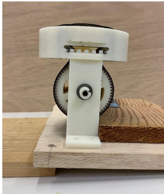
図 5-4 ベルト型第一世代 傾け輸送試験系
