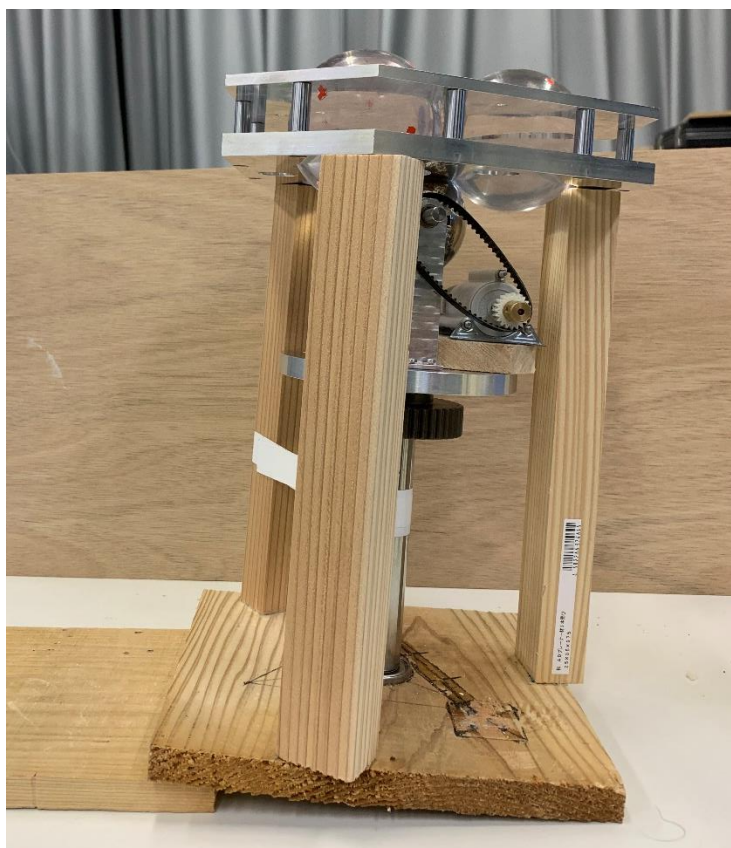
図 5-3 球体型第二世代 傾け輸送試験系
