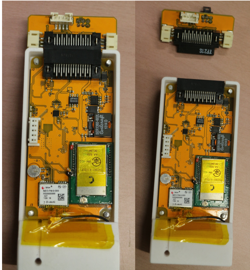
図 11 フライトコントローラーの接続、取り外しの状態
