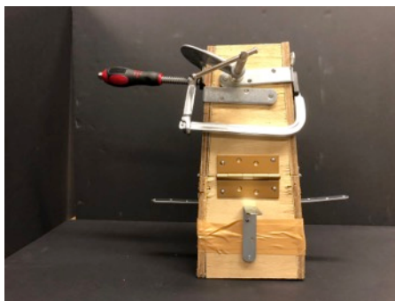
図 4-3 万力で固定している状態
