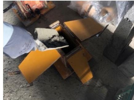
図 4-5 コンクリートを流し込んでいる様子
