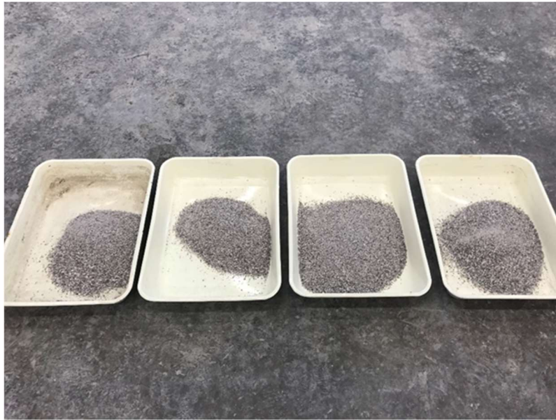
図- 3.2 各層の絶対乾燥状態の細骨材
