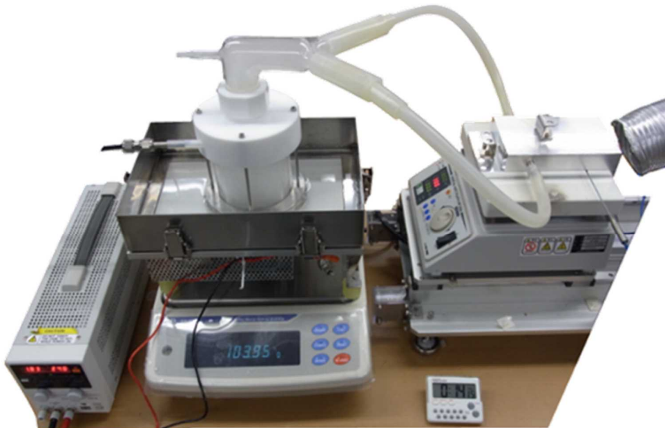
Fig. 2-1 本研究で使用したファインチャンネル方式ミストCVDシステム。
