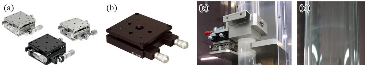
Fig. Apx.1-6 石英管の位置および角度調整のために導入した(a)XY軸調整テーブル(XYSCG80, ミスミ)と (b)傾斜テーブル(TD-902, 中央精機)。(c)2つのテーブルを筐体に設置されたステーに固定し、別の治具を用いて石英管を保持する機構とした。これにより、3軸の調整を正確に行うことが可能となった。(d)位置調整機構を導入後にZnO薄膜を成膜した石英管の様子。ZnO薄膜が途切れることなく一様に円筒管内壁に成膜されていることが確認できる。
