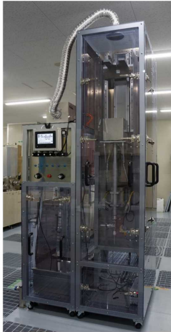
Fig. Apx.1-2 KAGUYA全景。ミストCVDの成膜対象を、平板平面から曲面へ拡張することを目指して開発中である。成膜の可否の認識の容易であることから、成膜基材には内径70 mm、長さ700 mmの石英管を選択した。成膜技術の開発のためには、膨大な回数の成膜実験が必要となる。そこで、成膜後は酸やアルカリを用いてエッチングを行い、薄膜を除去し、同じ基材を再使用することを想定している。そのため、使用する基材には化学的安定性が求められる。
