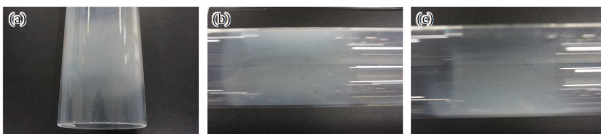
Fig. Apx.1-3 KAGUYAによるZnO薄膜形成実験の結果。形成された薄膜が白濁していることが確認できる。また、薄膜の形成に分布が生じており、(a)薄膜が形成されている面と(b)薄膜の形成が認められない面が確認できる。
