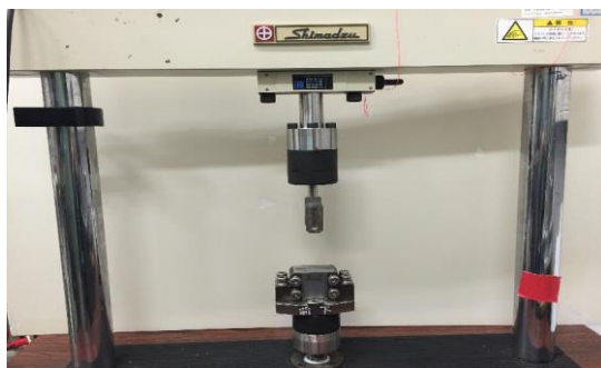
図 30 油圧サーボ疲労試験機と三点曲げ試験概略図 [mm]
