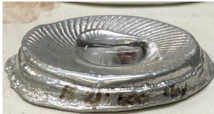
図 7.6 作製した基板で回転するライデンフロスト液滴
