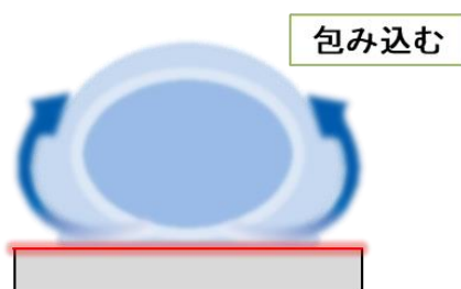
図 2.3 平衡ポテンシャル上におけるライデンフロスト状液滴の挙動
