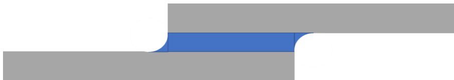
図2 フィレットを付けた接着継手のイメージ
