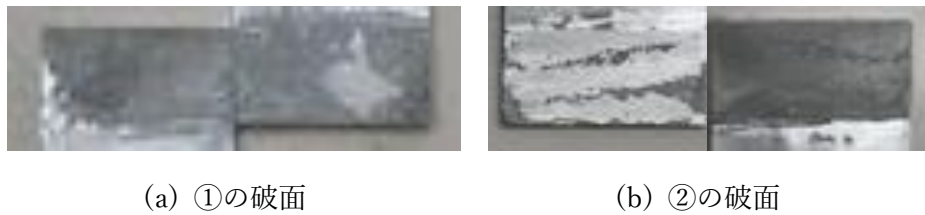
図 20 SLJ 試験片の接着破面例
