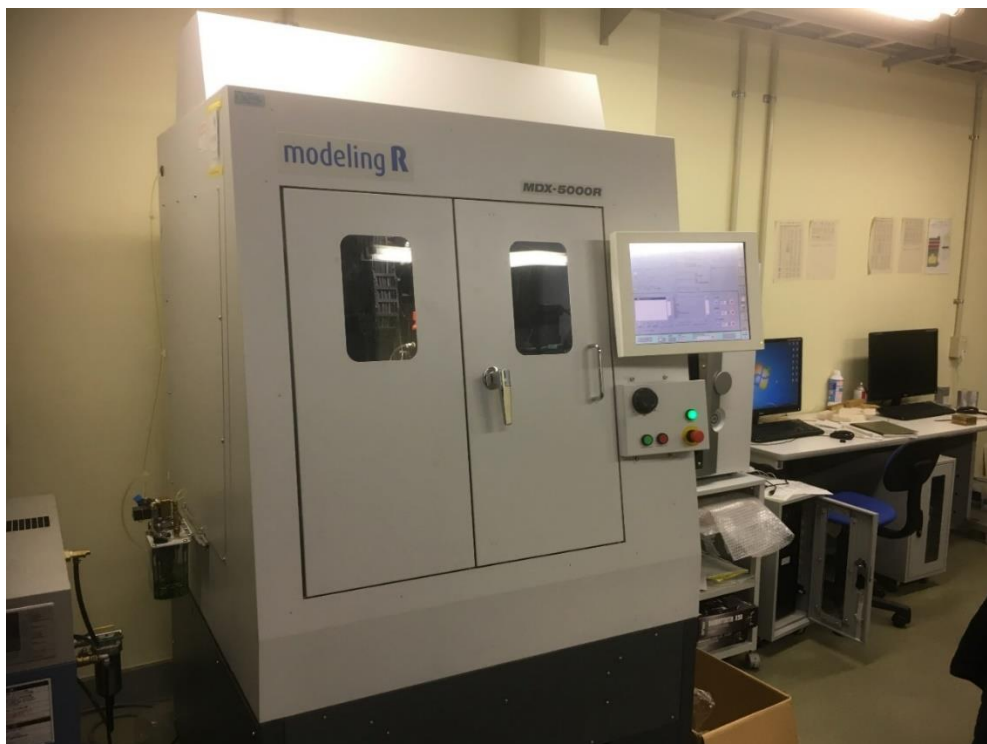
図 3.11 三軸加工機 Roland 製の MDX-5000R
