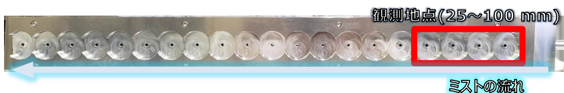
図 2.17 観測装置における流入口・流出口・観測位置(上流・下流)
