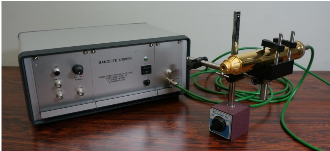
図 2.7 高速光源装置
