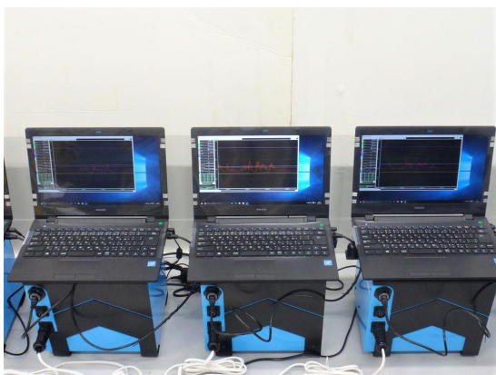
図 2.1 高知工科大学と株式会社 SAYA と共同開発した複合型インフラサウンド津波センサー ADXII INF01[16]
