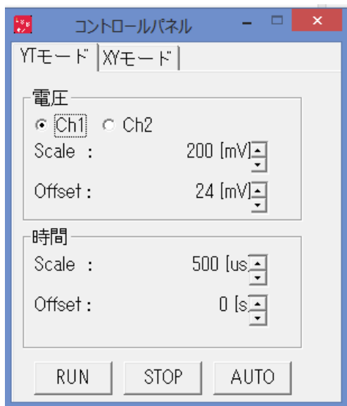
図 15: コントロールパネルの外観
