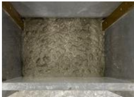
図-2. 10 間隙通過後のフレッシュコンクリートの状態
