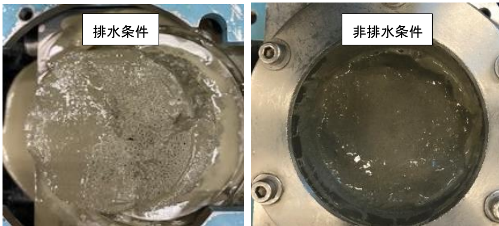
図-2. 9 一面せん断試験後のモルタルの状態
