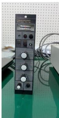
図 2.22 アンプ DSA-605C Strain-Amp
