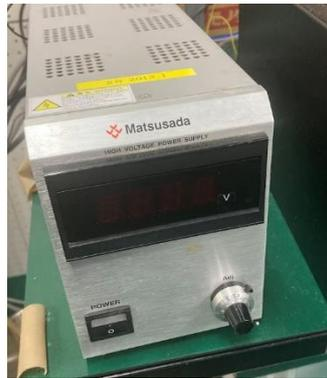
図 2.20 高電圧源 Matsusada Precision HJPM-1P3
