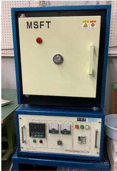
図 2.8 高温電気炉
