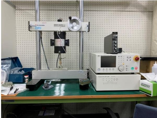
図 2.18 電磁力式微小試験機 (SHIMADZU, MMT-101N)
