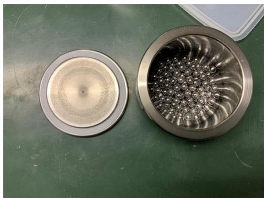
図 2.1 ステンレス球と容器
