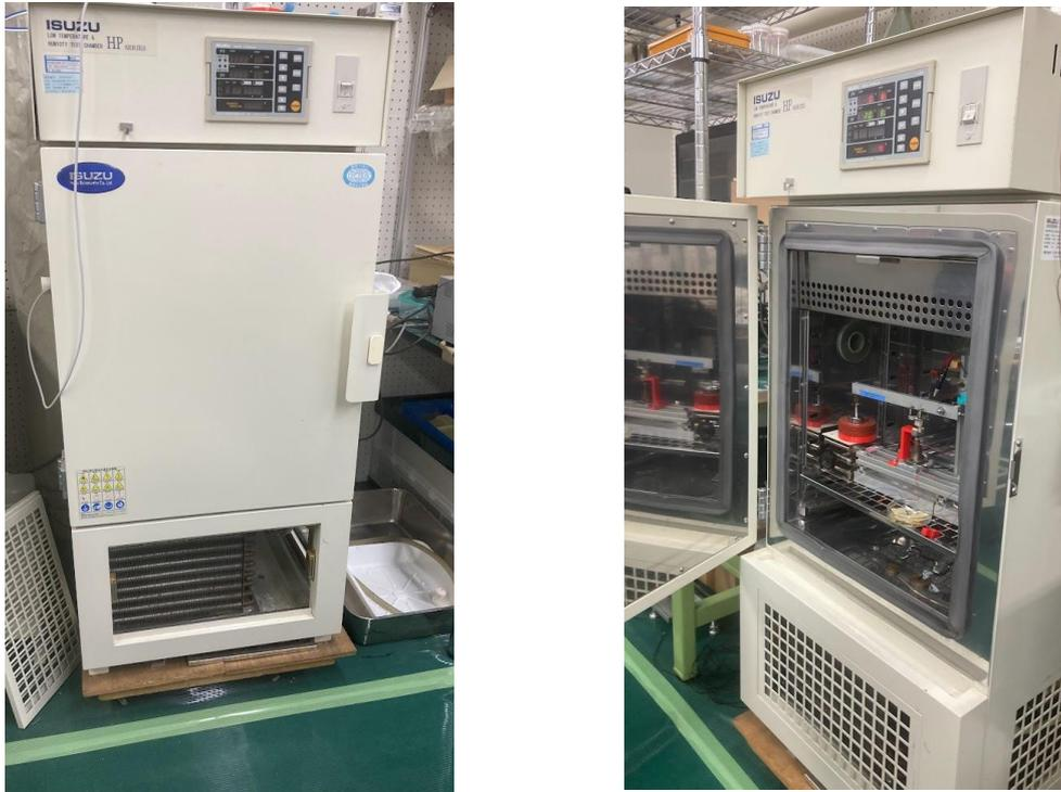
図 2.24 恒温恒湿槽 HPAV-48-20 いすゞ製作所，試験中の様子
