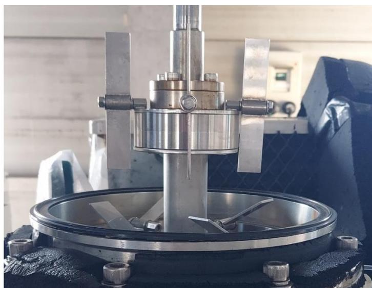
図 4-1 2 段攪拌翼 設置状態
