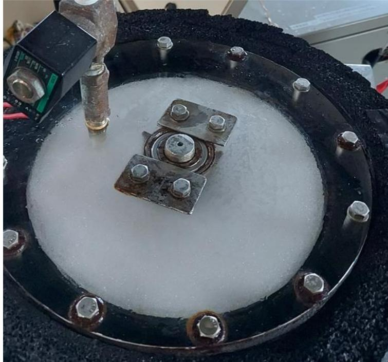
図 2-3 製氷機内閉塞発生(塩水抜水後)
