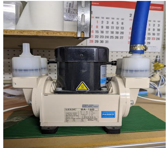
図 3.1.16 真空ポンプ ULVAC
