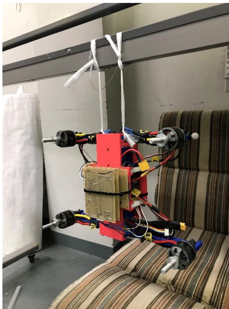
図 5.9 二点釣法を用いた慣性モーメント計測
