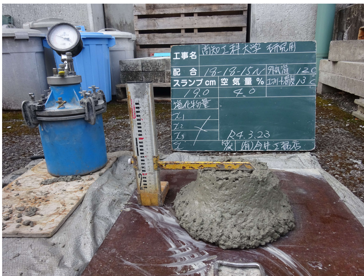
図 3.1.3 スランプ試験時の写真
