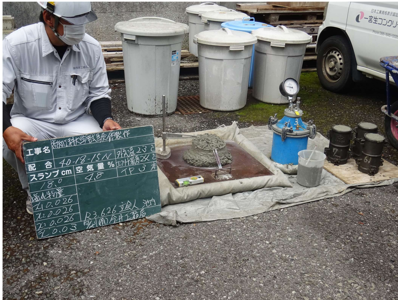
図 2.1.11 スランプ試験時の写真
