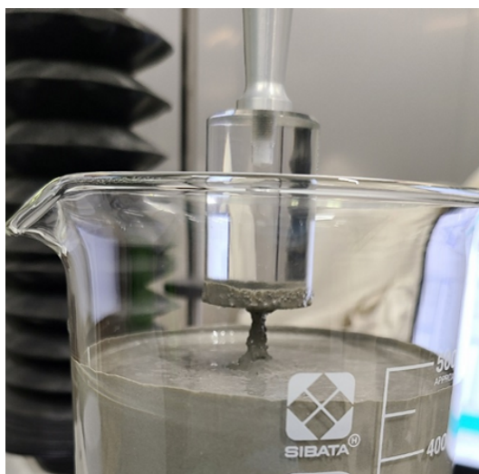
図-2.16 測定中のモルタルの様子 (モルタル試料から抜け出た治具とモルタルが剥離する瞬間)
