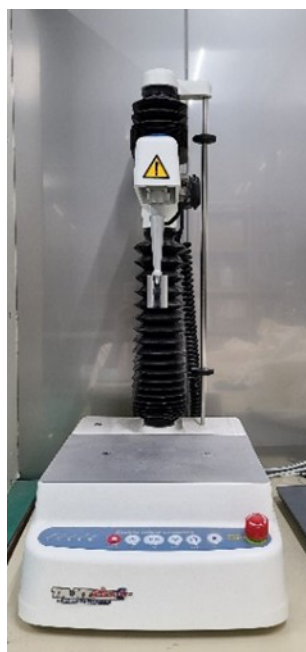
図-2.13 TA.XT plus C テクスチャーアナライザー（英弘精機製）
