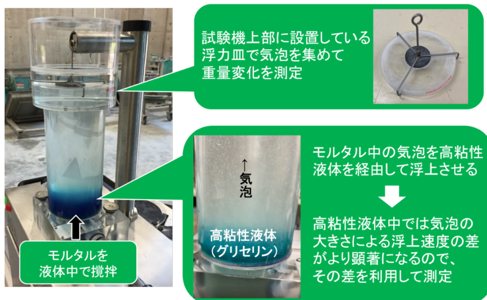
図-4.5 自動空気泡解析装置 (Air Void Analyzer : AVA)
