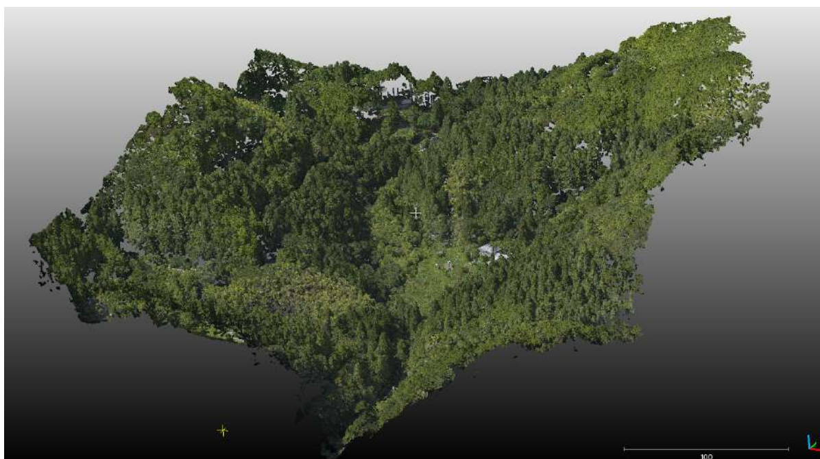
図 3.13 SfM で作成した里山研究フィールドの 3 次元点群モデル
