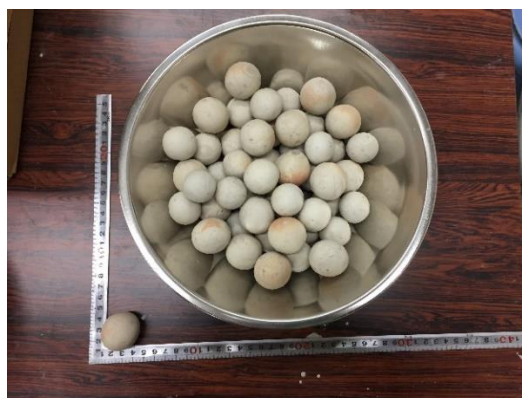
図-2.13 ボールミルに入れるアルミナ製ボール
