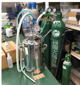
図-3.1 炭酸水を調整するための加圧容器
