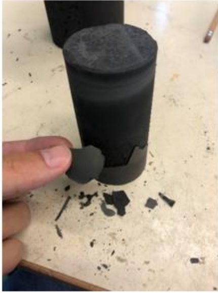
図-C.6 体積収縮による剥離（二酸化炭素濃度：1712mg/L）
