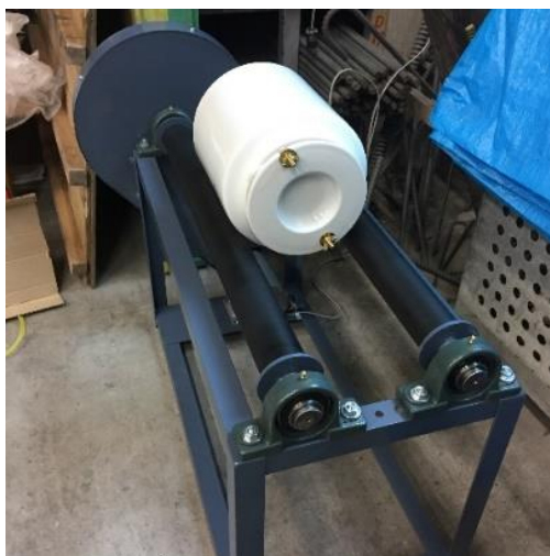
図-2.12 磁製ボールミル（粉碎用ボール）と回転台
