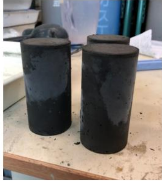
図-C.6 体積収縮による剥離（二酸化炭素濃度：1712mg/L）
