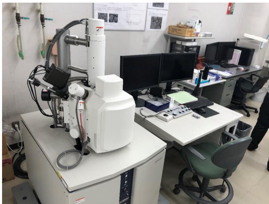
図-5.6 走査電子顕微鏡（SEM）とエネルギー分散型 X 線分光器（EDS）
