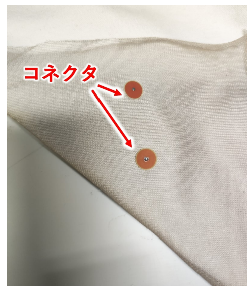
図 2.6 裏面の導電層。コネクタを介して受信デバイスは GND と接続されている。
