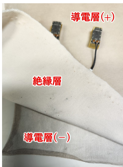
図 2.5 二次元導電布の構造
