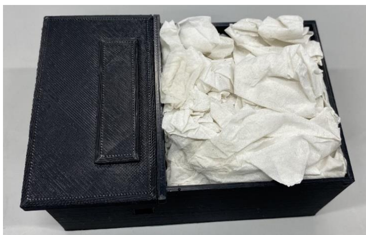
図 2.16 防水性能の確認のため防水軽量型データロガーBOXの防水加工側の部屋(右)にトイレットペーパーを詰めた様子
