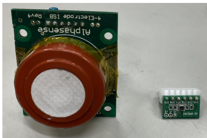
図 2.4 図 2.3 の左の部屋に入っている機器類の外観。左 : NO2 センサ(NO2-B43F) 右 : 温湿度・気圧センサモジュール(AE-BME280)
