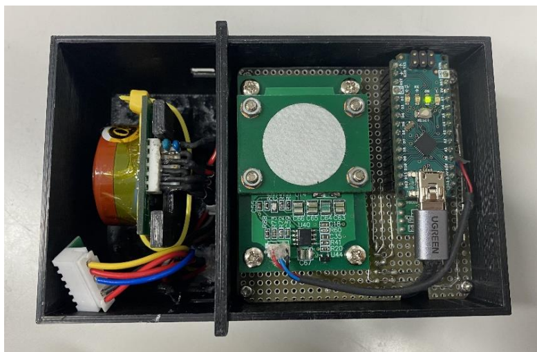
図 2.2 防水軽量型データロガーBOXの中の実装状態
