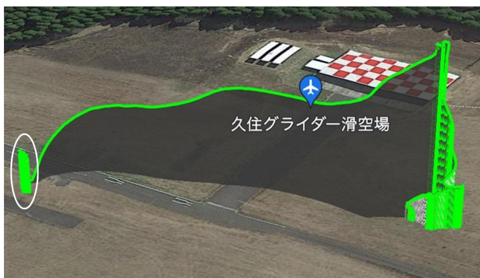
図 3.5 滑空実験一回目の誘導回収型観測機の滑空経路を Google Earth 上にプロットした様子（白丸で囲っている軌跡は着陸の衝撃を観測したと考えられ、実際は飛行していない）
