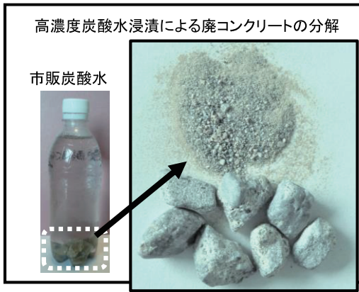
図 18. 市販高濃度炭酸水への浸漬による廃コンクリートの分解（予備実験）
