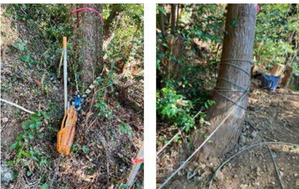
図 25. ベルトスリングとチルホール（木側）
