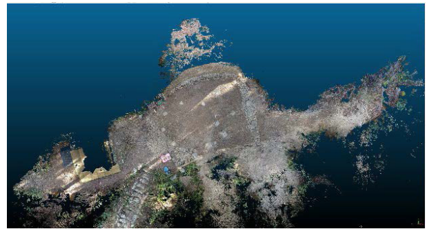
図 17. 整地終了後の点群データ
