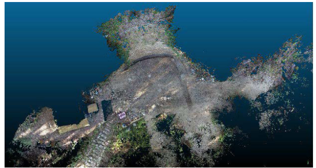
図 16. 掘削・水路の床堀後の点群データ
