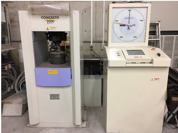
図 10. コンクリート圧縮試験機械
