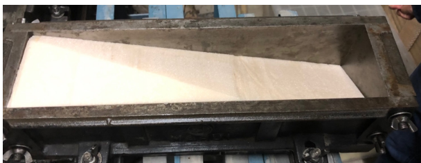
図 15. スペーサーブロック用型枠
