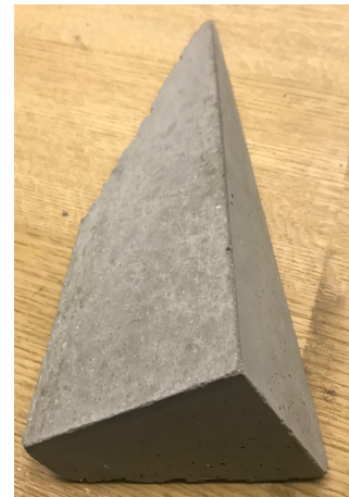
図 17. 完成したスペーサーブロック
