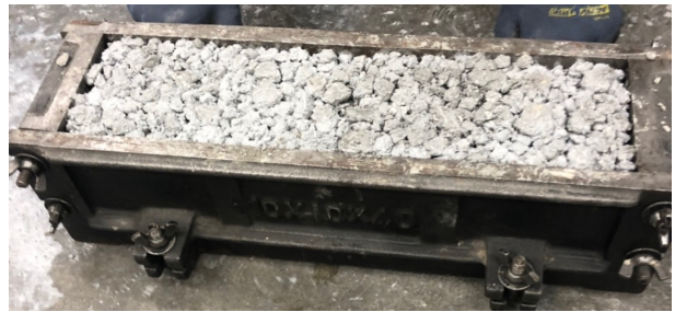
図 9. 型枠に充填されたポーラスコンクリート
