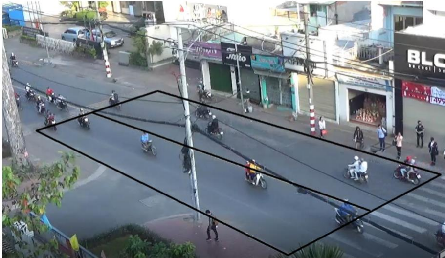
図 5.1.1 Vo Van Ngan 通りにおける交通流率,交通密度計測のための動画設定例
