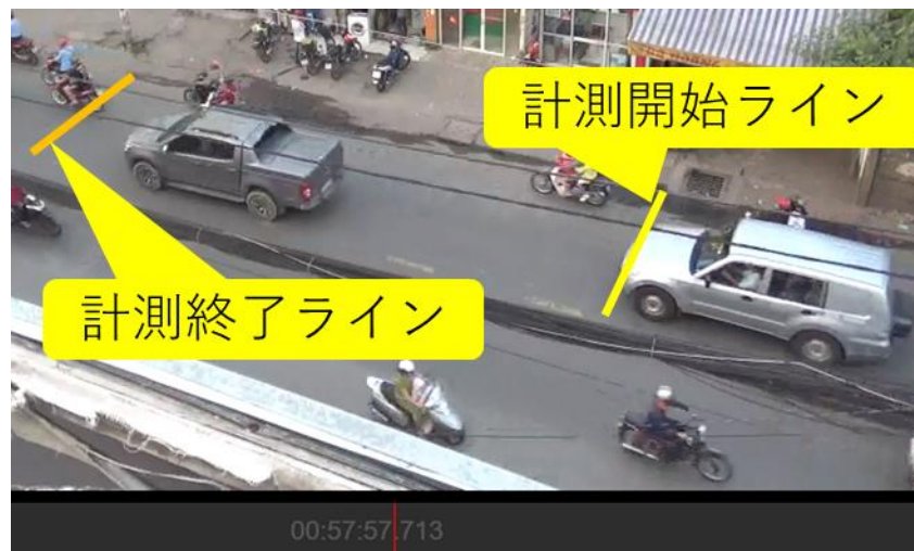
図 6.3.1 計測開始ラインと計測終了ライン
