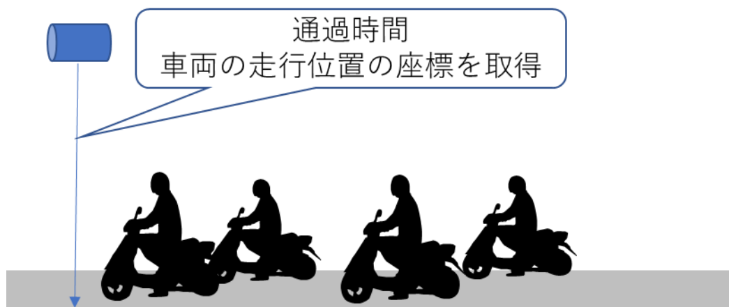
図 1.3.1 混合交通流においてラインスキャナーによる交通観測イメージ
