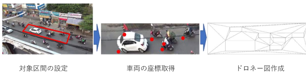
図 6.2.1 ドロネー図作図手順
