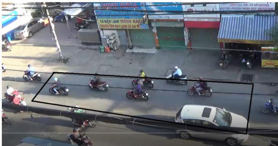
図 5.1.2 Le Van Viet 通りにおける交通流率, 交通密度計測のための動画設定例
