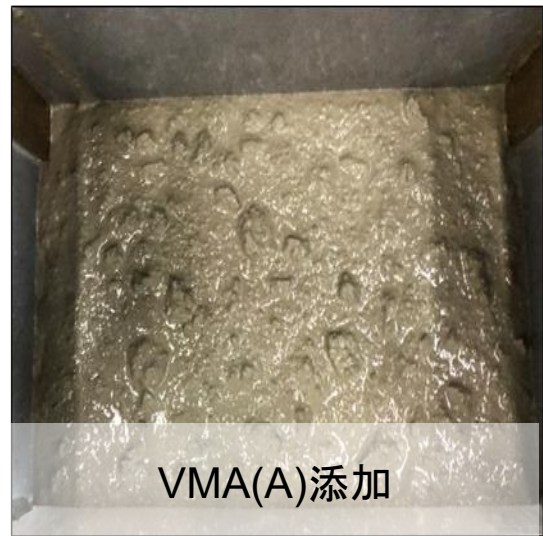
図-1.3 VMAによるモルタルと粗骨材の一体流動性の付与
